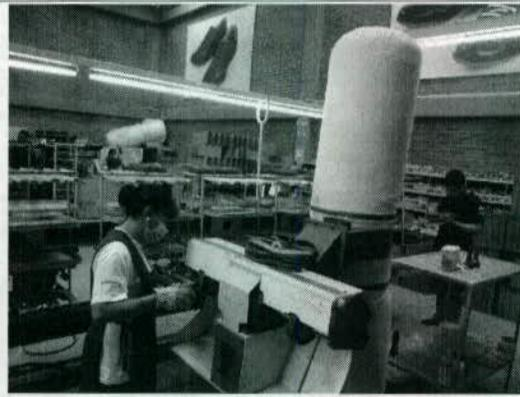
Foto 8 (Predio 2). Equipo para terminado de suelas con sistema de recolección de material generado.
